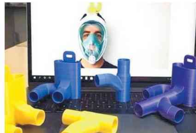
Le maschere da sub possono essere trasformate in ventilatori
