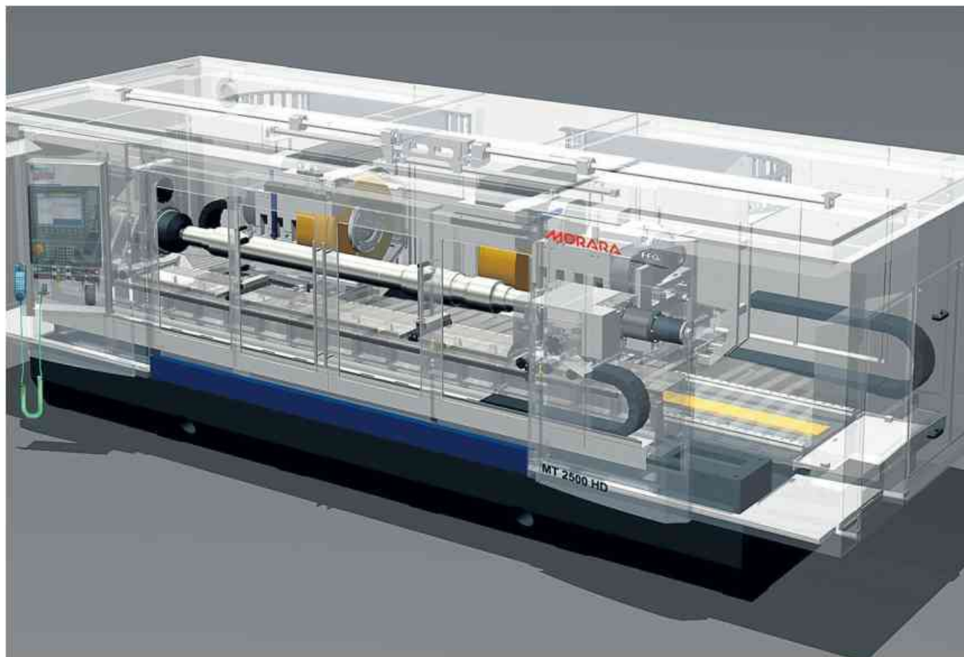
Il progetto della nuova rettificatrice per assili ferroviari di Grinding Technology che raggruppa i marchi Tacchella, Morara e Meccanodora
