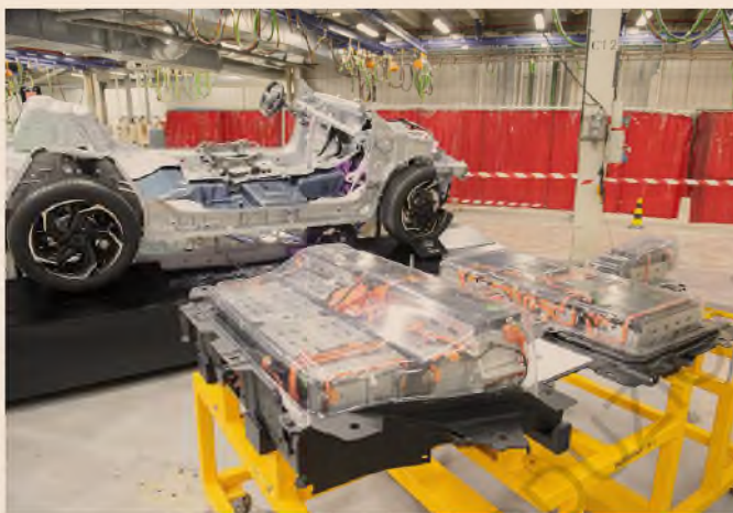
Multi energia. Nella foto la piattaforma modulare Cmp del gruppo Psa che dà vita a modelli elettrici o a combustione interna già in commercio come la Peugeot 208 e che sarà sfruttata anche per vetture di altri brand
