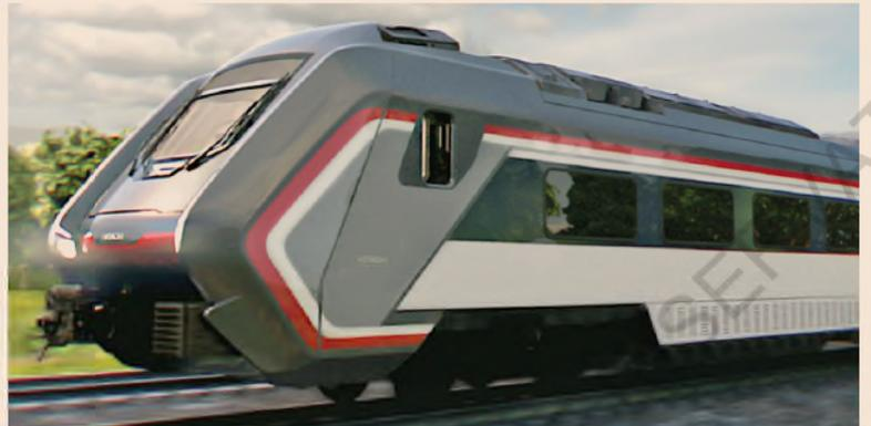
Nuova generazione. Il rendering del treno ibrido commissionato da Trenitalia a Hitachi. Ora in fase di progettazione, potrà essere alimentato con pantografo elettrico, diesel e batterie. I convogli saranno costruiti negli stabilimenti italiani di Hitachi: Pistoia, Napoli e Reggio Calabria
