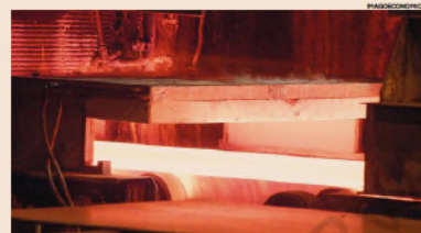
Laminatoio. La lavorazione di una barra d'acciaio in un impianto Arvedi.
