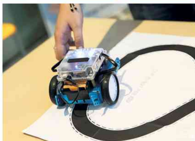
I test per programmare i mini-robot e farli muovere su percorsi preordinati
