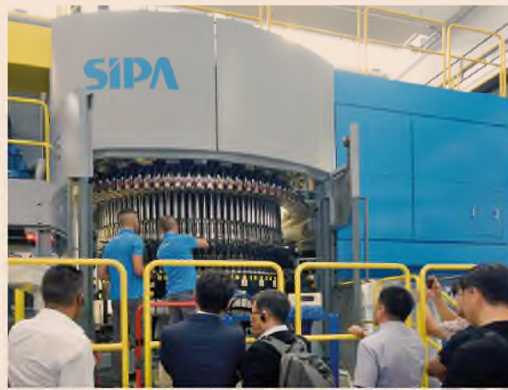
Chiedere il cerchio. La linea di imbottigliamento che usa plastica riciclata per produrre nuove bottiglie di Pet
