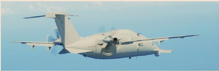
In volo, il sistema P.11H HammerHead è un drone utilizzato per il controllo del territorio e dello spazio aereo
